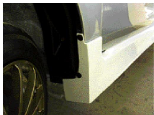
④ リアフェンダー部分に、クリップナットを取り付け、六角タッピングネジで固定。
